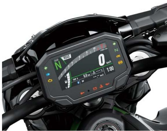
Modurile de pilotaj integrate care conectează KTRC și Power Mode permit piloților să seteze cu ușurință controlul tracțiunii și livrarea de putere pentru a se adapta la o anumită situație de rulare. Piloții pot alege dintre trei setări (Sport, Road, Rain) sau o setare manuală (Rider). În modul manual Rider, fiecare dintre sisteme poate fi setat independent.
