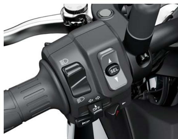
Sistemul avansat de control al tracțiunii Kawasaki oferă atât performanțe sporite de pilotaj sportiv, cât și încrederea de a aborda cu încredere suprafețele cu aderență redusă. Trei moduri selectabile de către pilot oferă niveluri progresive de intruziune pentru a se adapta la situația de pilotaj și la preferințele pilotului.
