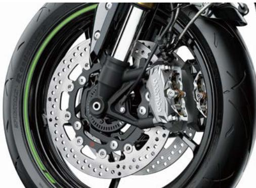
Pachetul de frâne față cu componente Brembo oferă o putere de frânare mai mare și contribuie la un control și mai precis și la o mai mare ușurință de utilizare. Discurile față Brembo de Ø 300 mm și etriurile monobloc cu montare radială M4.32 sunt completeate de o pompă radială Nissin și conducte din oțel inoxidabil pentru a oferi o putere de frânare mai mare și o progresie mai liniară la acționarea manetei de frână.
