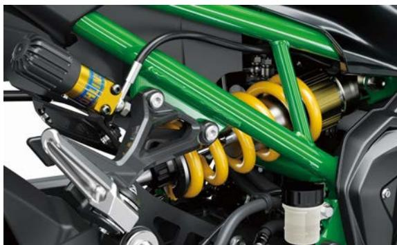
Furca inversată de diametru mare, de culoare aurie, cu reglaj mai mare, este completată de un amortizor spate Öhlins S46 pentru un confort sporit și un sentiment superior de aderență și manevrabilitate. Suspensia spate este, de asemenea, echipată cu reglare a pretensionării la mână, care facilitează ajustarea setărilor fără unelte pentru a se adapta la pilotajul cu pasager sau cu bagaje.
