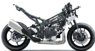
Proiectat cu ajutorul analizei avansate de rigiditate dinamică Kawasaki, acest cadru de tip grindă cu zăbrele realizat din oțel de înaltă rezistență oferă echilibrul necesar de rezistență și flexibilitate a șasiului pentru a obține manevrabilitatea agilă de tip supersport a modelului Ninja ZX-4R.
