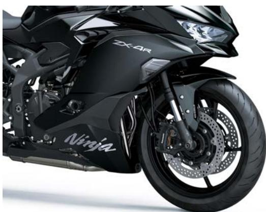
Furca inversată de ø37 mm a modelului Ninja ZX-4R folosește componente interne SFF-BP pentru a oferi atât performanțe pe circuit, cât și utilizare zilnică, în timp ce suspensia spate Horizontal Back-link oferă un caracter progresiv. Oferind o reglabilitate sporită, furcile față ale lui Ninja ZX-4R SE și ZX-4RR includ pretensionarea reglabilă a arcului, iar Ninja ZX-4RR dispune de un amortizor spate Showa BFRC lite - același tip întâlnit pe Ninja ZX-10R.
