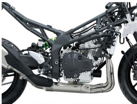
Kawasaki ridică performanța motorului de 400 cmc la un nou nivel, atingând o putere fără precedent de 57 kW (77 PS)\*. Urletul motorului atunci când trece de 15.000 min-1 la turație se adaugă la entuziasmul pilotului. Natura rapidă a turației și răspunsul direct al accelerării sunt completate de un caracter flexibil care oferă un cuplu puternic la turații joase și medii pentru condusul în oraș, precum și o putere tipătoare la turații înalte, ideală pentru condusul sportiv sau pe circuit.
