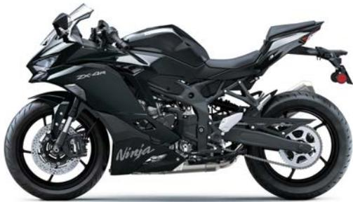
Dimensiunile cheie ale șasiului (poziția centrului de greutate, poziția pivotului basculei spate, pozițiile axei motorului, unghiul de fugă etc.) au fost inspirate de modelul Kawasaki World Superbike Ninja ZX-10RR, aducând gândirea de proiectare a șasiului WorldSBK la clasa de 400 cmc.
