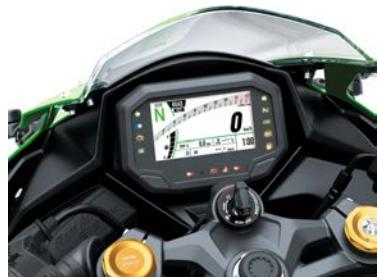
Patru moduri de pilotaj integrate (Sport, Road, Rain sau Rider (manual)) simplifică selectarea unui nivel de control al tracțiunii și a unui mod de putere care să se potrivească condițiilor actuale de rulare.
