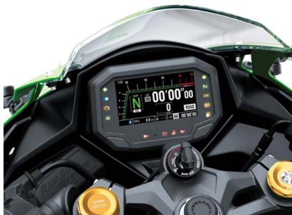
Instrumentarul de bord color TFT complet digital de 4,3" cu moduri de afișare selectabile (Normal, Circuit) afișează în mod clar cele mai relevante informații, fie pe stradă, fie pe circuit. Modul Circuit afișează mai vizibil poziția treptelor de viteză, timpii pe tur și turațiile peste 10.000 rpm.
